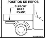
Le support de bras de levage approuvé est remisé sous la plate-forme, côté passager, de la machine.
