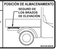
El seguro homologado del cajón de carga está almacenado debajo del propio cajón, en el lado del pasajero de la máquina.
